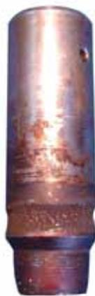
Рис. 5. Повреждение плунжера клапана в результате кавитации
