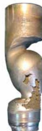
Рис. 6. Повреждение плунжера клапана в результате флешинга
